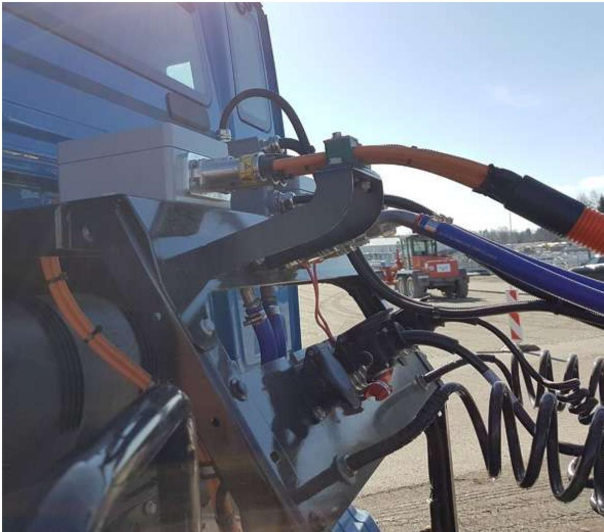
HVC8 ist ein Steckverbinder für Hochstromanwendungen. Das robuste Design und die hochwertigen Materialien ermöglichen den zuverlässigen Betrieb von Elektromotoren, Generatoren oder Wechselrichtern auch unter extremen
